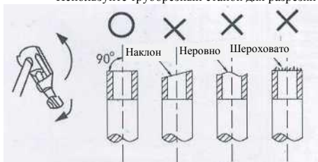
Рисунок 4-1 Обрезка соединяющей трубы
