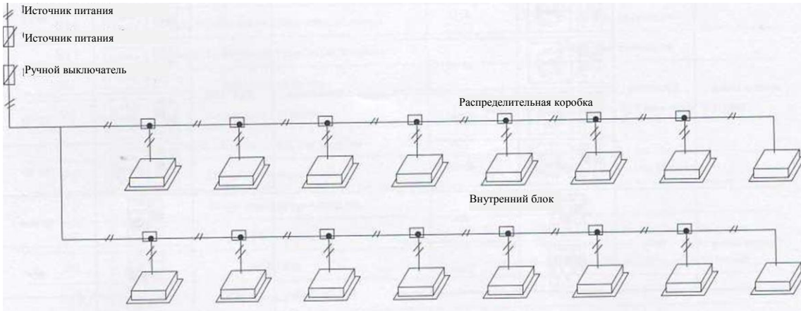
Рисунок 5-4 Электропроводка внутреннего блока
